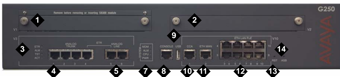
图 5：G250-BRI 前面板的端口和插槽
